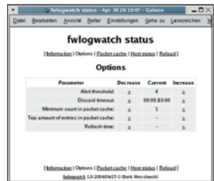
Abbildung 6: Im Browser kann der Anwender FWlogwatch konfigurieren. Der Alert Threshold bestimmt die Anzahl der Meldungen, ab der FWlogwatch seine Antwortskripte startet.
