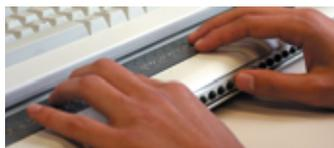
Bei blinden Computerbenutzern ersetzt die Braillezeile den Monitor.
