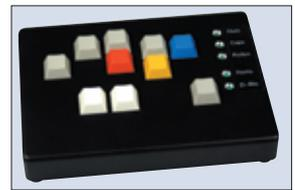
Dieses Spezialkeyboard (hier für Linkshänder) ersetzt mit nur zehn Tasten eine herkömmliche MF-2-Tastatur.
