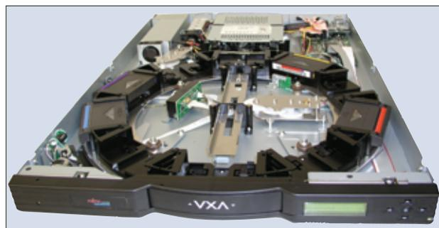
**Abbildung 3:** Blick ins Innenleben eines neuen Bandwechslers von Exabyte, der unter anderem von Fujitsu-Siemens gehandelt wird. Das nur eine Höheneinheit beanspruchende Gerät fasst unkomprimiert 800 GByte. (Foto: Fujitsu-Siemens)
