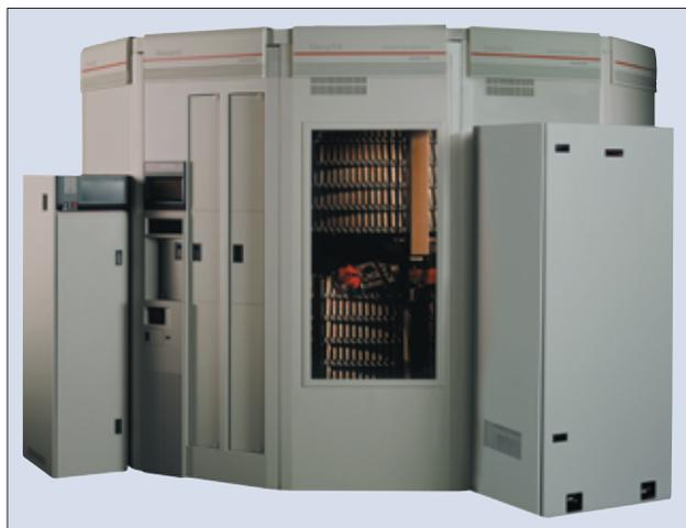
**Abbildung 2:** Eine der größten Tape-Libraries ist die Powderhorn 9310 von Storagetek. Auf bis zu 144 000 Bandkassetten bringt sie unglaubliche 28,8 Petabytes unter. (Foto: Storagetek)
