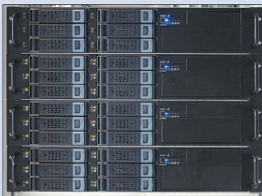
Abbildung 2: Das hier beschriebene Testsystem: Die drei unteren Rechner exportieren die Devices, das obere System mountet sie.
