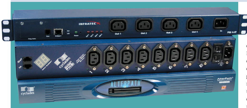
Abbildung 1: Die Cyclades PM8i-Leiste (Mitte) lässt sich seriell oder via Alterpath-Konsolenserver (unten) über einen Browser schalten. Der zu dem getesteten Infratec PRS PM 8 bauähnliche PM 4-IP (oben) ist dagegen nur über die Weboberfläche schaltbar.
