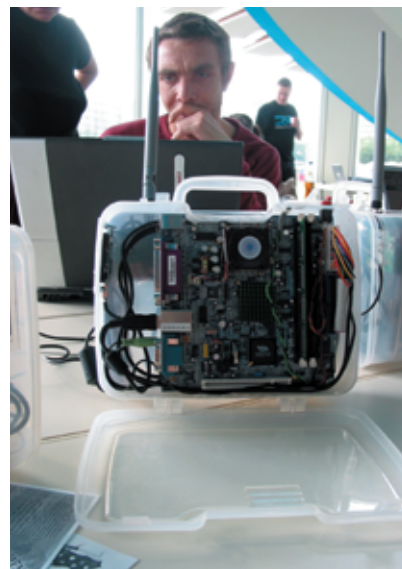
Abbildung 3: Tragbare Wireless-Knoten: In den Koffern der Rollergirls stecken Mini-ITX-Computer.
