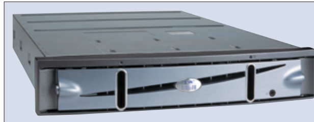
Das EMC AX100 schließt bis zu acht Server in einem SAN-Array zusammen.
