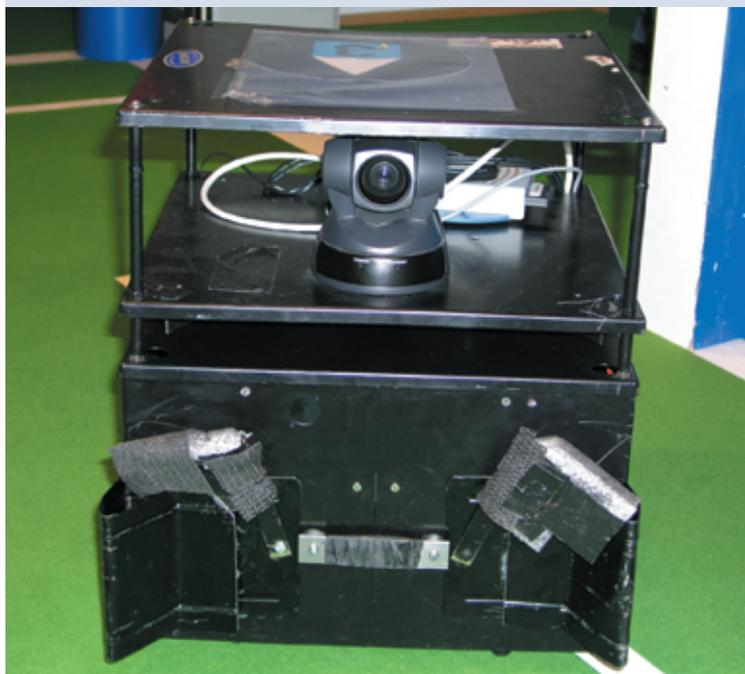
**Abbildung 1:** Die Roboter der Allemaniacs sind mit 50 Kilo wahre Schwergewichte. Unter der oberen Abdeckung ist die drehbare Kamera zur Ortung des Balls angebracht, eine Etage darunter versteckt sich der Laser-Scanner.
