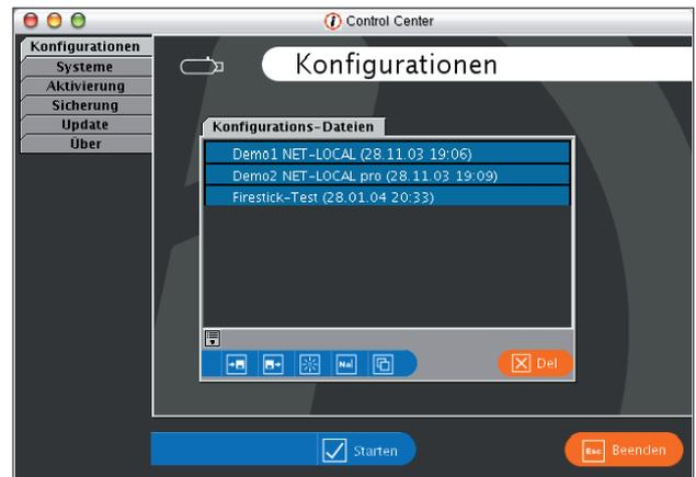
**Abbildung 2:** Das Control Center dient als zentrale Schaltstelle der Firestick-Software. Am linken Rand ist das Hauptmenü angeordnet, in der Mitte sind drei Konfigurationsvarianten gelistet.
