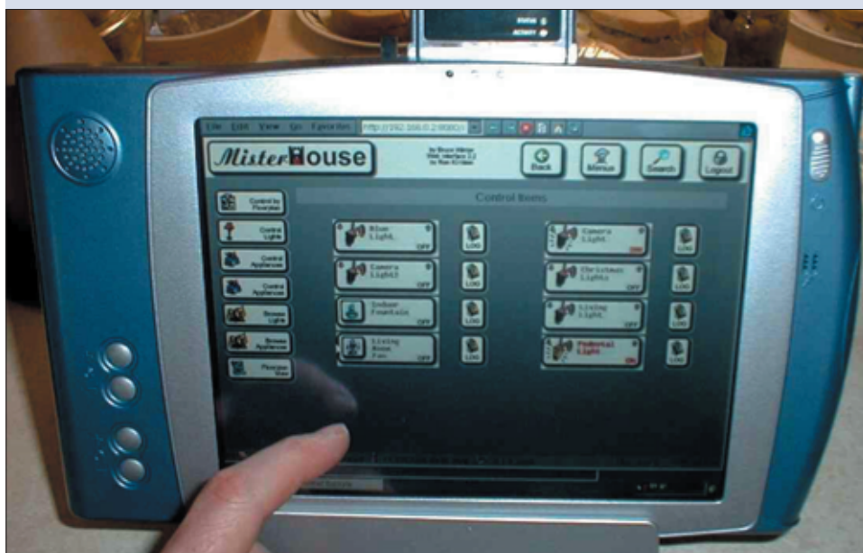
Abbildung 1: Mister House, die Software für das intelligente Haus. Über einen Webbrowser lässt sich jedes Gerät im Eigenheim steuern. Dazu bieten sich tragbare Computer wie dieses Aquapad an.
