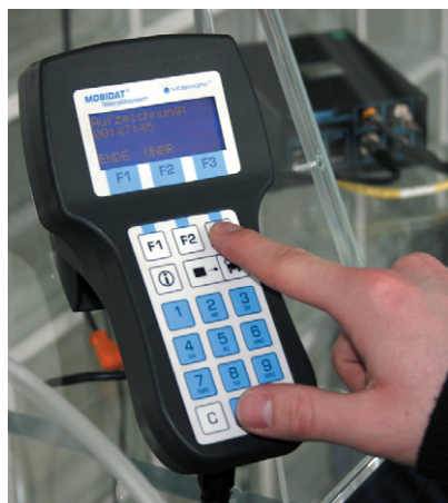
Abbildung 1: Die Bedieneinheit (BDE) des Mobidat-Systems zur Erfassung von Telematikdaten. Über sie steuert der Fahrer unter anderem den Versand von erfassten Daten an den Server.
