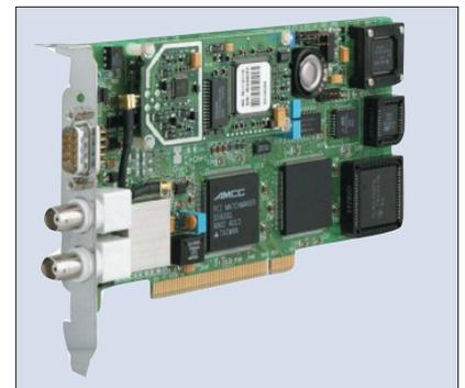
Abbildung 3: Per GPS-Einsteckkarte FG6039GPS von Hopf [10] bezieht das Netzwerk die Zeit aus dem Orbit. Die Karte erfordert den Anschluss einer Außenantenne, um das GPS-Signal einzufangen.
