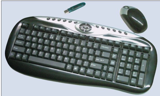
Abbildung 1: Das Bluetooth-Kit BT-Barton von Elito-Epox besteht aus Tastatur, Maus und USB-Dongle. Beim Systemstart emuliert das Dongle eine USB-Tastatur, das Programm »hid2hci« schaltet später um in den HCI-Modus.
