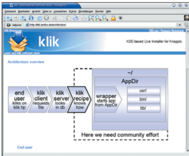
Ablauf einer Klik-Installation vom Mausklick des Anwenders bis zur automatischen Installation der Software in sein Homeverzeichnis.
