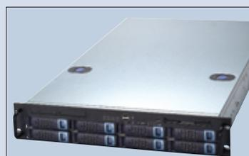
**Abbildung 1:** Der Testrechner Zero-One RM-250 von CTT ist mit acht SATA-Festplatten und einem entsprechenden Controller von 3Ware bestückt.
