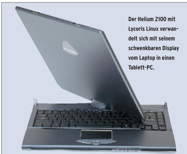
Der Helium 2100 mit Lycoris Linux verwandelt sich mit seinem schwenkbaren Display vom Laptop in einen Tablet-PC.
