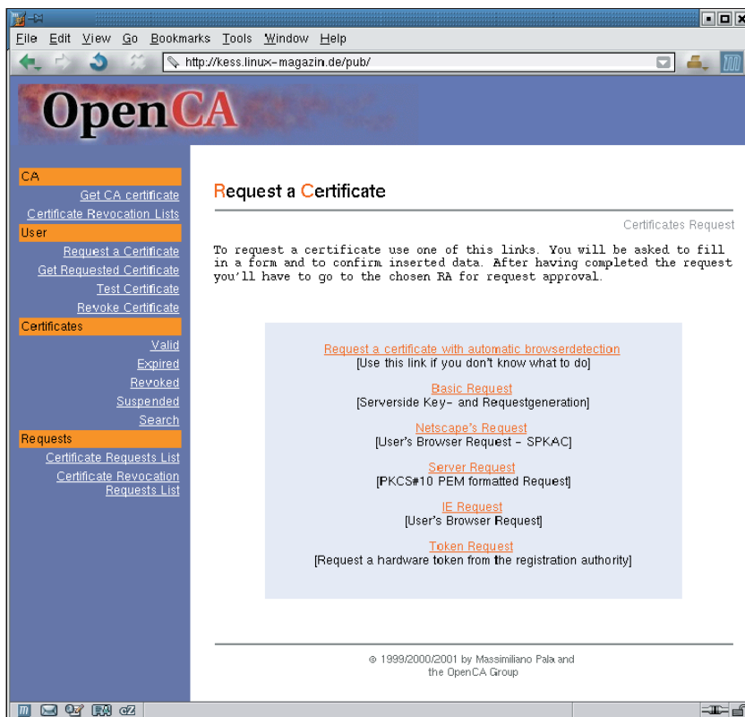
Abbildung 15: OpenCA lässt dem User die Wahl zwischen mehreren Formaten, in denen er seinen Zertifikatsantrag abgibt. Danach erzeugt der Browser das Schlüsselpaar und gibt den öffentlichen Key an die CA weiter.
