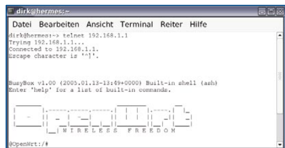
Figura 1: Para o primeiro login utilize o Telnet. O OpenWrt não solicita nenhuma senha de root, devido à conexão desprotegida.
