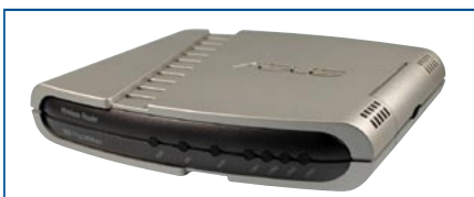
Figura 3: O roteador WL-500G da Asus utiliza a mesma base de hardware que o WRT54G da Linksys. O OpenWRT também funciona no novo modelo Asus WL-500GD.
