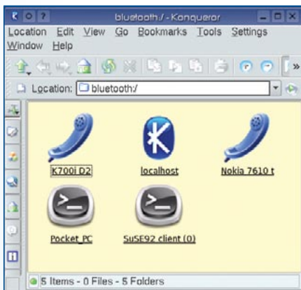
Figura 1: Além de si mesmo ( localhost ) o Konqueror vê dois celulares, um Pocket PC e outro PC de mesa.
