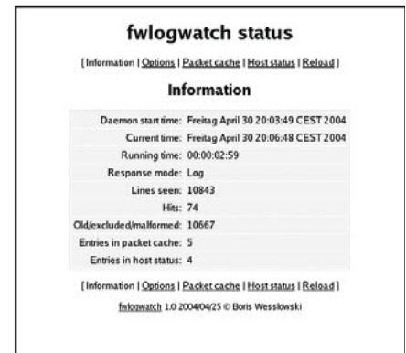
Figura 4: O servidor web embutido no fwlogwatch permite que o administrador monitore o estado atual do firewall.
