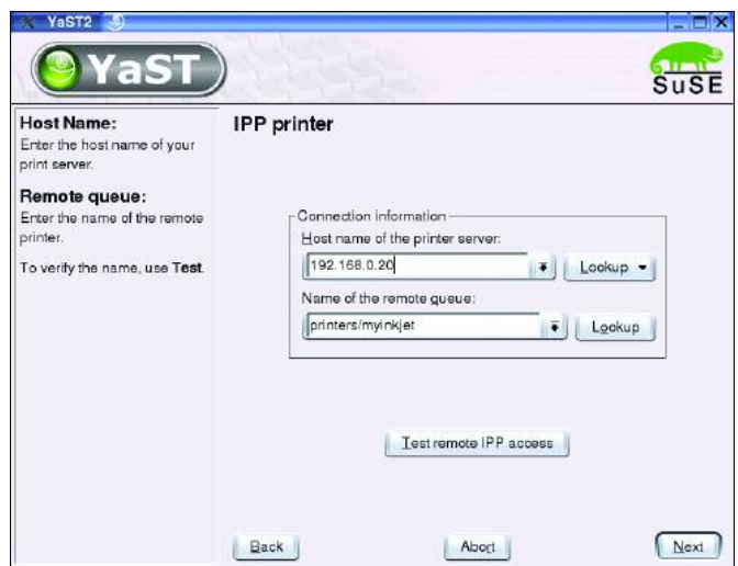
Figura 5b: ...e a seguir informe o nome do servidor e a URI para completar a configuração.
